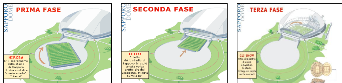
Figura 33 - Le fasi per la movimentazione del campo del Sapporo Dome
